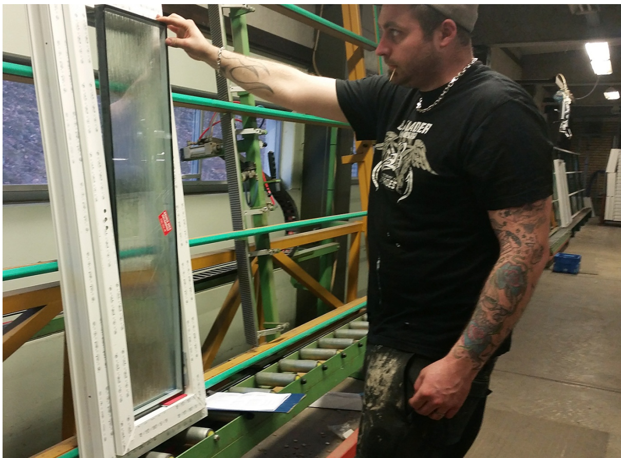
Lyft försiktigt in glaskassetten och ställ den ovanpå glasklossen.
