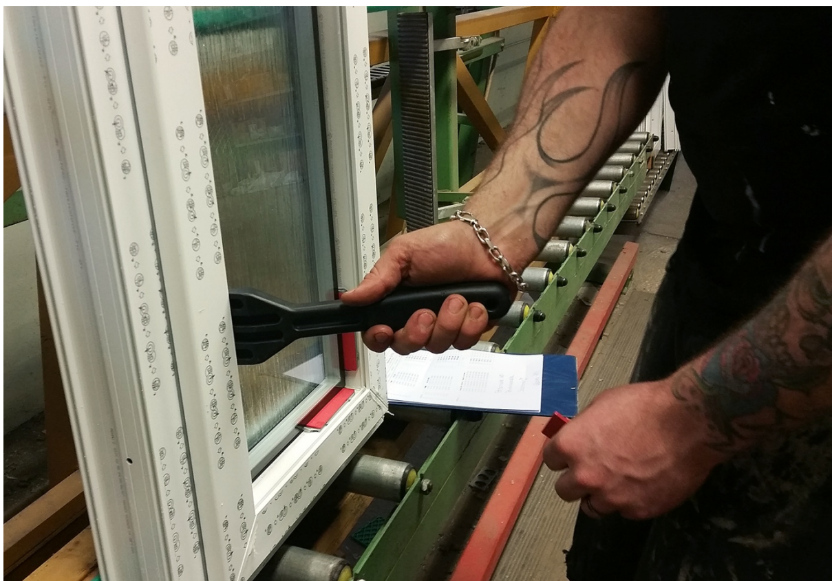
Lyft försiktigt in glaskassetten och ställ den ovanpå glasklossen.
